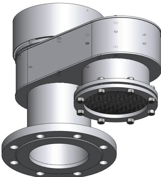
Princip rada: kad dostigne pritisak otvaranja, ventil deluje kao ventil sigurnosti, podizanjem zatvarača smanjuje pritisak u posudi. Pri pojavi vakuma (podpritisaka) ventil deluje kao vakuum brejker, otvara se usisna granai pritisak se ograničava na zadatu meru, tako da pritisak uvek varira do +/-10mbar od atmosferskog.
